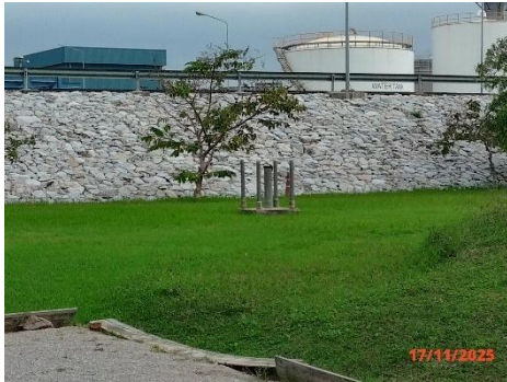
ภาพที่ 2-12 บ่อตรวจสอบคุณภาพน้ำใต้ดินในพื้นที่โรงไฟฟ้า
